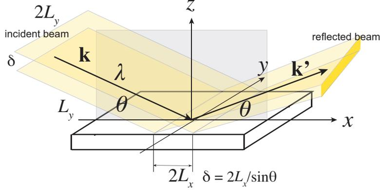
Figure 1: 鏡面反射の光学系
